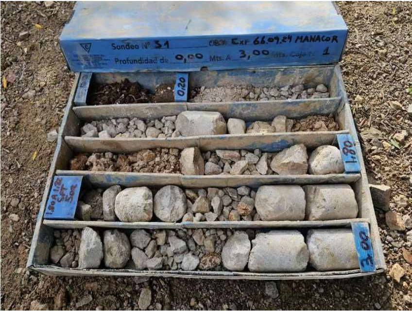
Foto 2: Caja porta testigos SONDEO 1 CAJA 1
