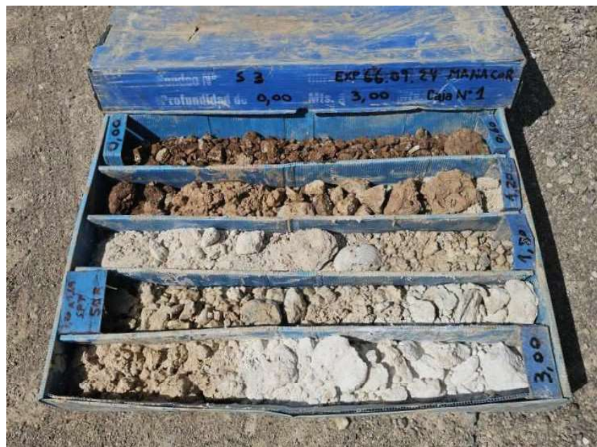
Foto 12: Caja porta testigos SONDEO 3 CAJA 1
