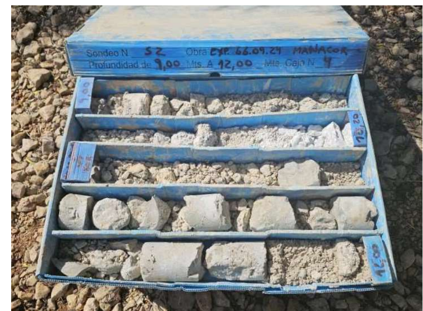
Foto 10: Caja porta testigos SONDEO 2 CAJA 4
