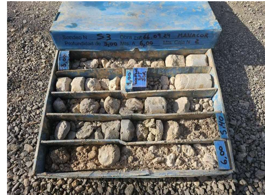
Foto 13: Caja porta testigos SONDEO 3 CAJA 2
