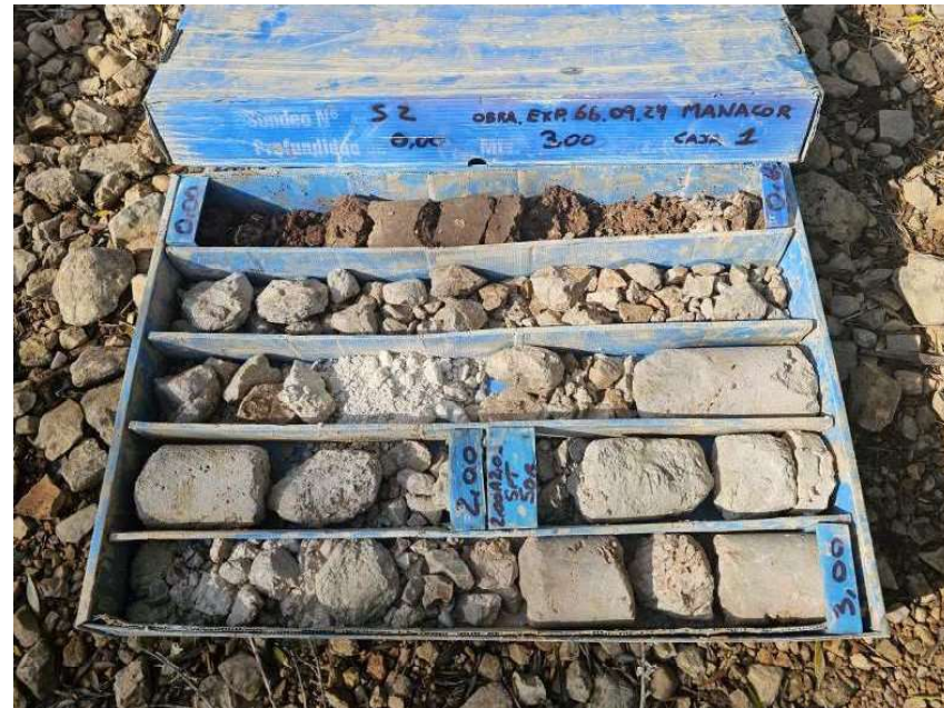
Foto 7: Caja porta testigos SONDEO 2 CAJA 1
