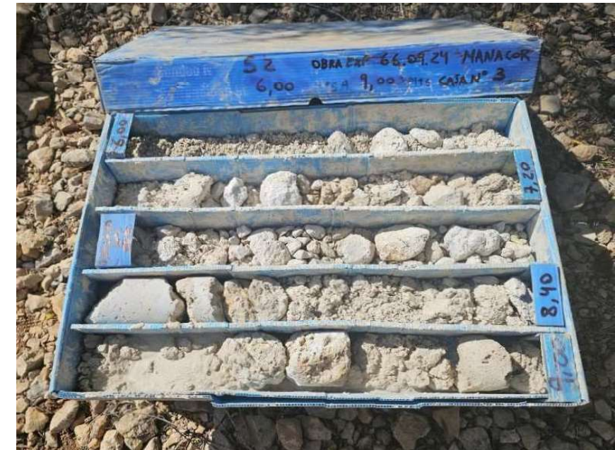
Foto 9: Caja porta testigos SONDEO 2 CAJA 3
